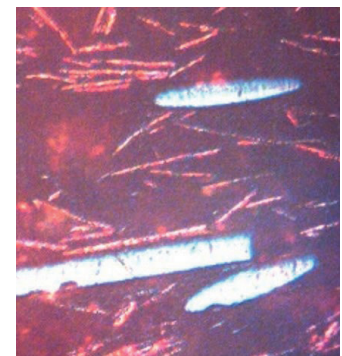
Bild 6. Interaktionskoeffizient für eine Mischung aus Mikroglasskugeln und Kupferplättchen (siehe Bild rechts) (Quelle: IKT)
